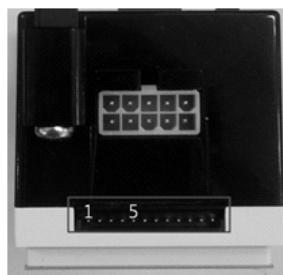
Рис. 5-2. Разъём сигнала дистанционного отключения
