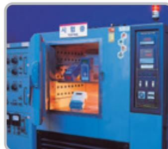
Испытание непрерывным воздействием высокой температуры
