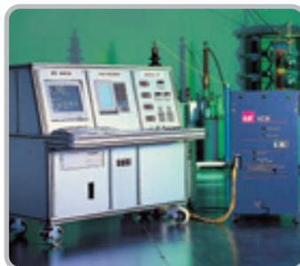
Проверка характеристик вакуумного автоматического выключателя
