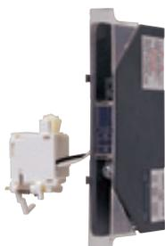
Минимальный расцепитель напряжения размыкает автоматический выключатель, если значение линейного напряжения падает до 35 - 70 % от номинального.
