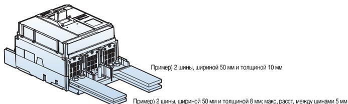
Присоединение шин спереди (только при установке на рейках)
